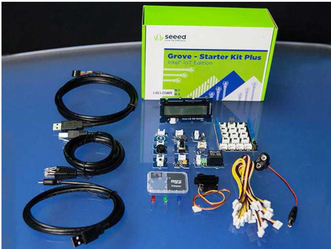
Rysunek 2. Zestaw sensorów i okablowania wchodzący w skład Grove Starter Kit Plus Intel IoT Edition
